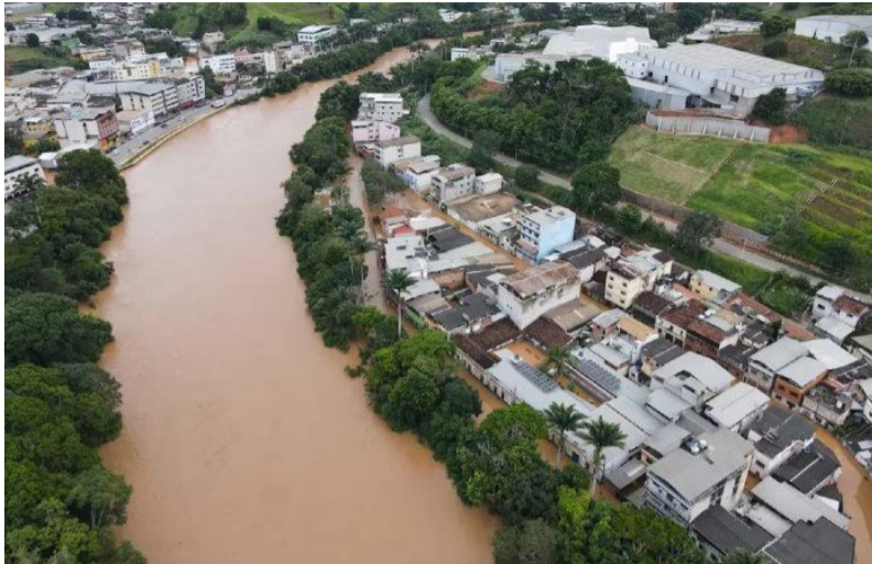
Margens do Rio Piranga no perímetro urbano foi ocupada desordenadamente e a nova lei pode aumentar o perigo de inundações, porque as construções nas APP provocarão alto nível de impermeabilização do solo
